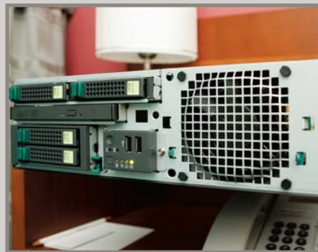
Ekologický server PRIMERGY TX120 so spotrebou len 163 W pri plnom zaťažení – spotrebu sme si mohli overiť priamo na pripojenom merači
